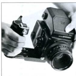
② カメラ底部の三脚シューに、グリップ側の溝を差しこみ、静かに中途まで挿入します。
