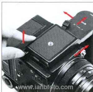
締付レバーを矢印の反対方向に回してゆるめ、ストップバーを押しさげながら、グリップをカメラボディから引きぬきます。
